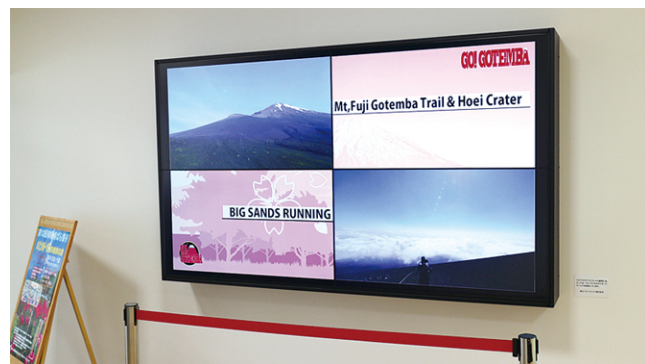
46インチ×4面のマルチスクリーン構成で80インチ相当の大画面を実現。 (写真は、4分割フォーマットでの画面表示)
