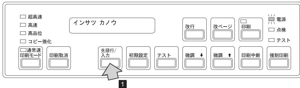
TOFインジケーターと用紙ミシン目が合った状態で [先頭行/入力] を押すと 1 用紙が一定量後退し、印刷開始位置とミシン目が一致します。
