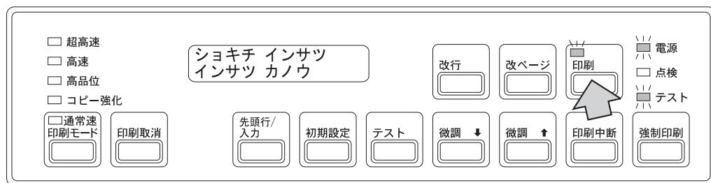
初期設定の印刷は、下図のような初期設定値の一覧が1ページ(11インチ用紙で)印刷されて自動的に終了します。
