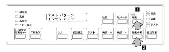
補足: テスト印字は長さ11インチ(279 mm) の用紙1ページ分を印字すると自動 的に停止します。テスト印字を途中で中止させるときは**印刷中断** を押しま す 2 。ただし、テスト印字を途中で中止させると、先頭行位置がずれます。
