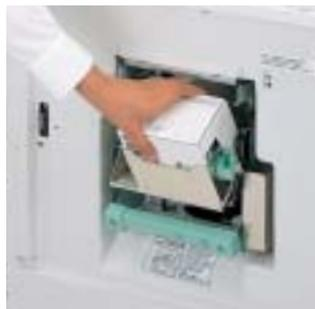
本体の前カバーを開けて、インキホルダーを手前に傾け交換します。
